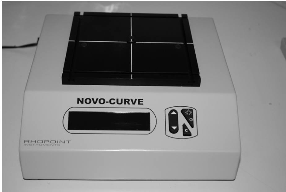
Εικόνα 7. Γωνιοφωτόμετρο Novo – Curve (Rhopoint instruments, Dexhill on sea, UK)
