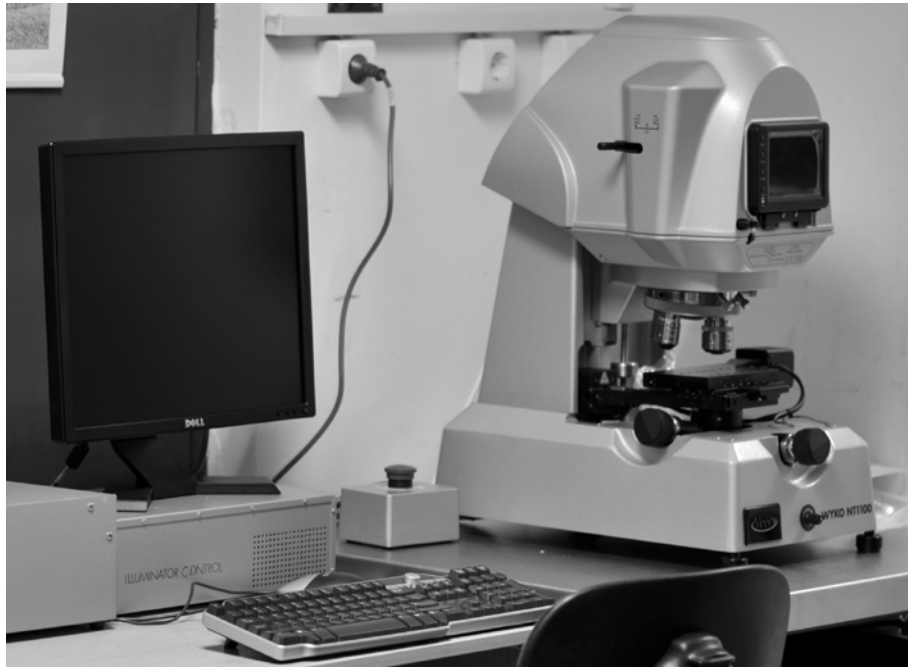
Εικόνα 8. Οπτικό Προφιλόμετρο Wyko NT 1100 (Veeco, Tuscon, AZ, USA)
