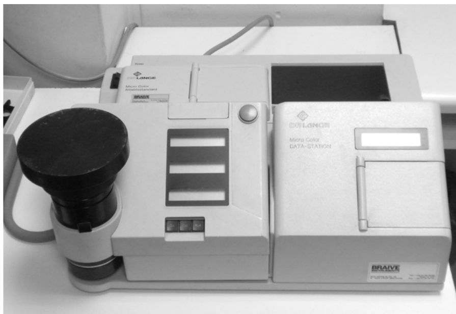
Εικόνα 6. Χρωματόμετρο DrLange Micro Color (Dr Bruno Lange GmbH, Dusseldorf, Germany)
